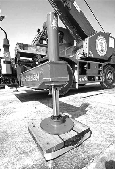
アウトリガー。クレーン車やコンクリートポンプ車などが物を吊ったりブームを伸ばしたりする際に、車体横に張り出して接地させる事で車体を安定させる装置。
